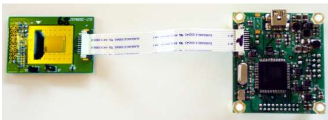
図3-1-2 指紋センサー検証用モジュールの接続図
