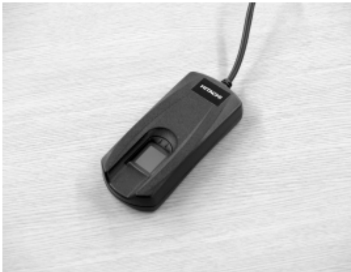
図表 3-2 USB 接続型指紋読取装置（日立製作所製）
