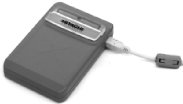
図表 3-1 ISO/IEC 14443-TypeB 準拠 IC カードリーダーライター（日立製作所製）
