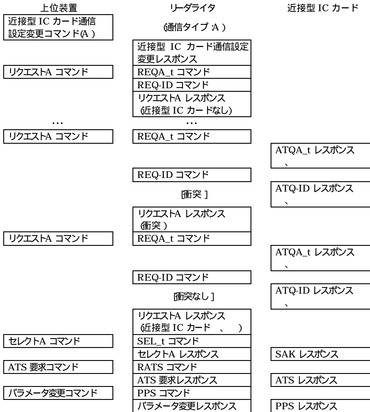
図 16 . 6 - 4 タイプ A 近接型 IC カード検出シーケンス
