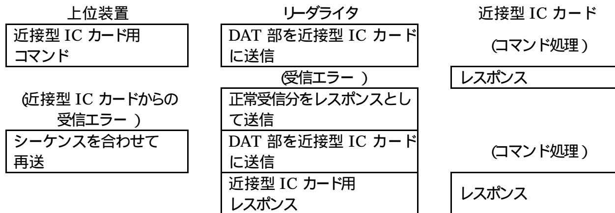
図 16 . 6 - 10 近接型 IC カード通信エラーシーケンス 1
