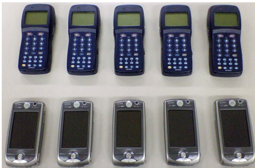
図 6-2 実証実験で使用する電子タグリーダー・ライター (上) と携帯電話 (下)
