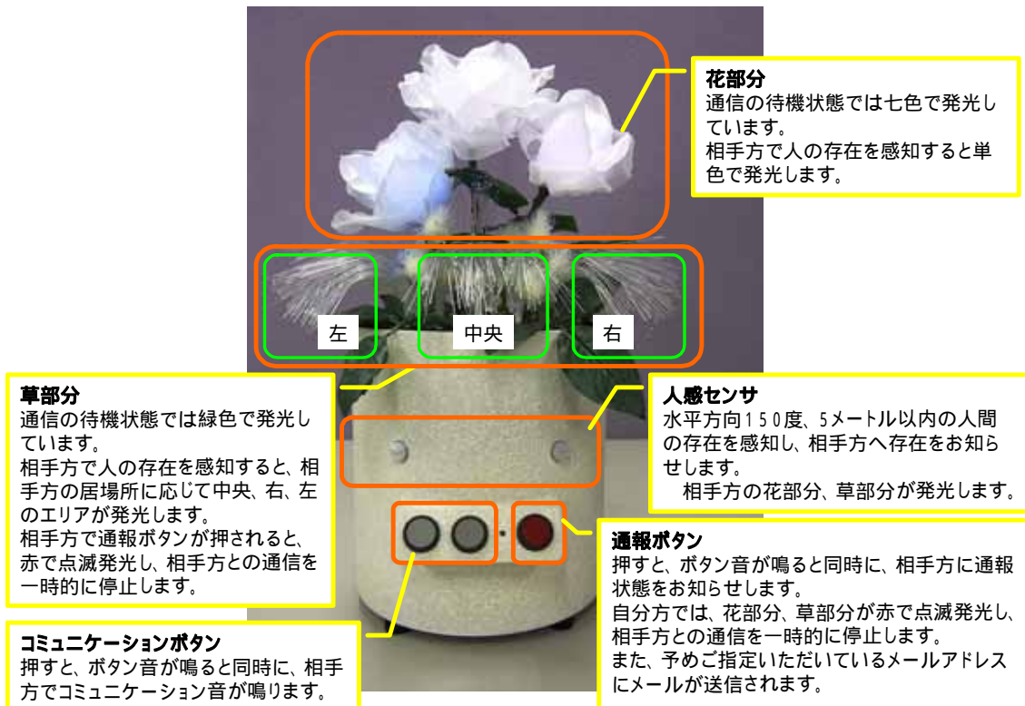
図 4.1.2-3 センサ内蔵端末の機能
