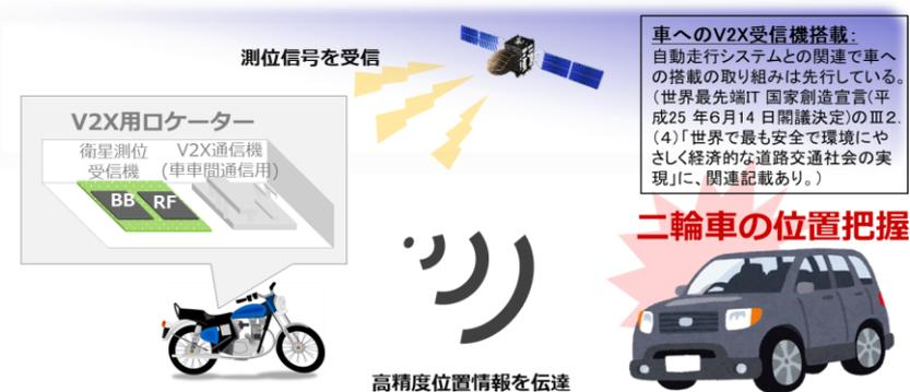
GNSS(準天頂衛星 他)からの信号をもとに算出した高精度位置情報をV2Xを用いて二輪車から車へ送信し、二輪車の位置を認識させる。
