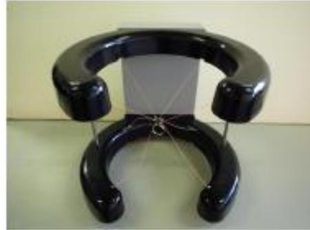
図6 SPIDAR-GCC(指先提示用)
