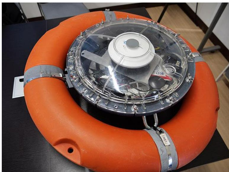
図 3.4 センチメータ級とサブメータ級測位補強サービスの対応受信機を搭載した海洋ブイ
