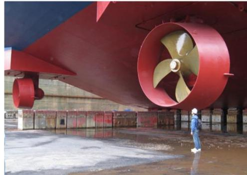
プロペラ推進方向を360度回転させ、自由に推力方向を変えることが可能なアジマススラスト
