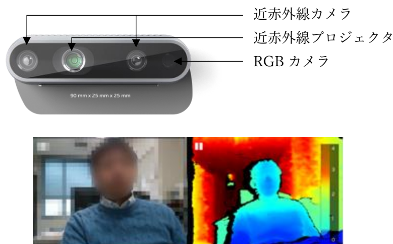
図 5.8.3 Intel RealSense と撮影画像例
