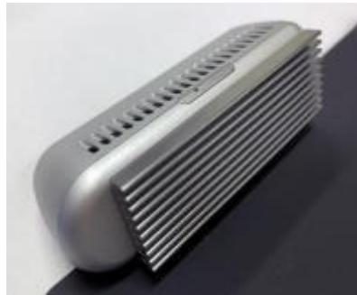
図 5.8.16 背面にヒートシンクを装着した RealSense
