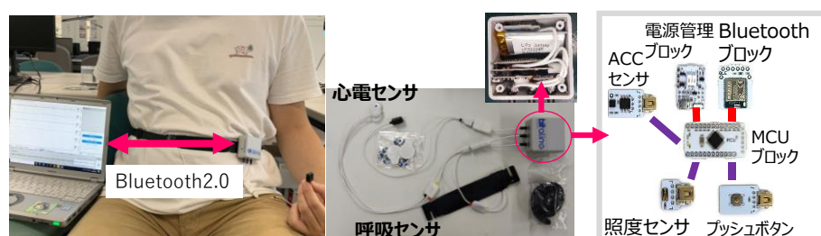
図 5.7.2 BITalino を用いて試作(特注)した腰ベルト式生体計測装置試作装置
