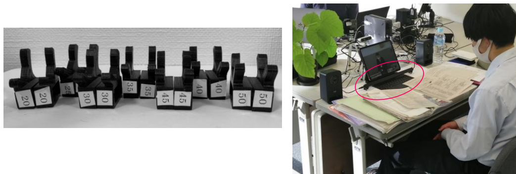
図 5.9.1 アイトラッカー設置用治具 (左) と配置例 (右)
