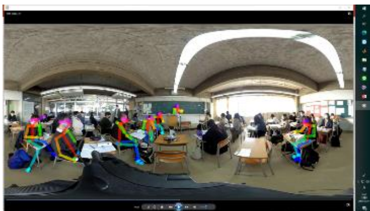
図 5.6.7 360° 動画への OpenPose 適用例(1) (坐位後部からの検出率は悪い)
