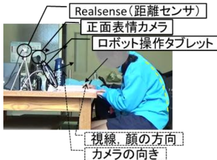
図 5.8.2 実証実験時の機器配置例
