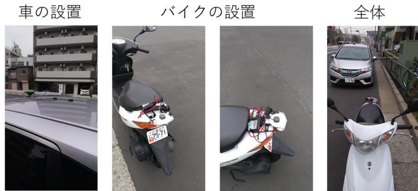
図 4-32 GNSS 受信機とアンテナの設置状況（自動車と原付）
